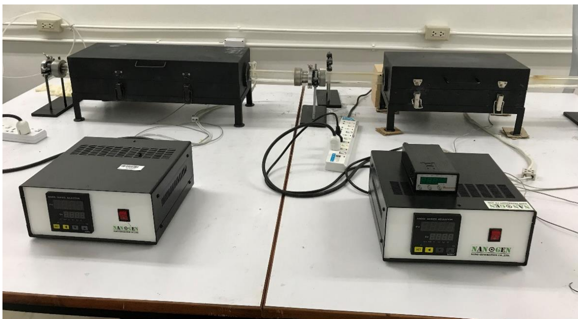
รูป 5 ชุดเตาเผาที่ใช้ในการสังเคราะห์แกรฟีนบนนิกเกิลโพลีเมอร์โดยวิธีการเคลือบผิวด้วยไอเคมีโดยใช้ขยะพลาสติกเป็นแหล่งคาร์บอน
