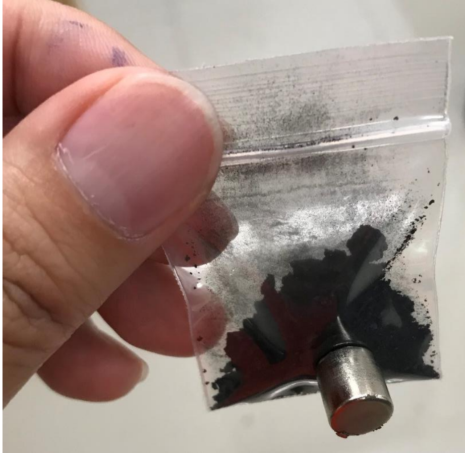
รูป 8 แกรไฟีนผงหุ้มเหล็กที่ใช้น้ำตาลและสารละลาย \text{FeCl}_3 เป็นวัตถุดิบในการสังเคราะห์
