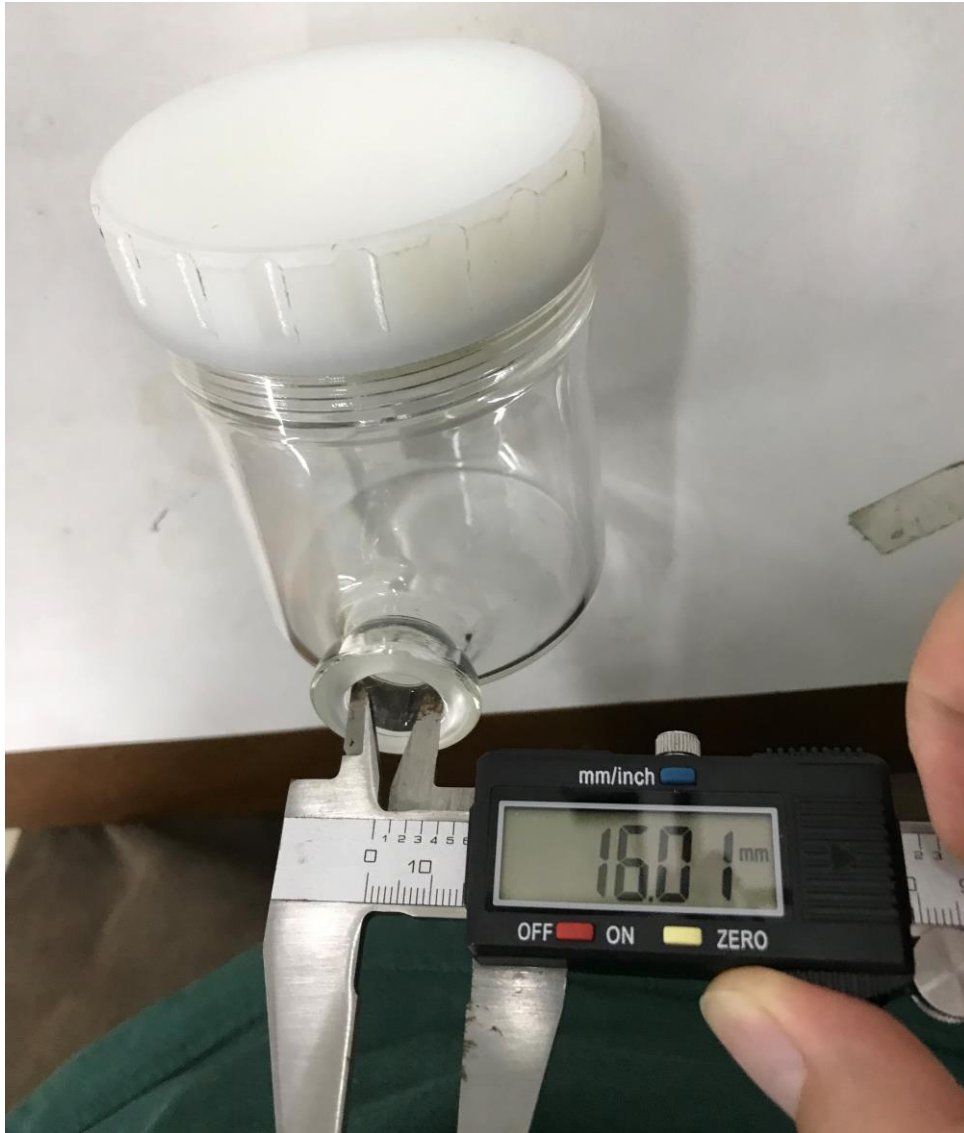
รูป 53 ขนาดของรูที่ให้อากาศไหลผ่านสำหรับการทดสอบประสิทธิภาพผ่านกรองฝุ่นแกรฟีนโฟม
