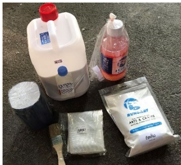
ภาพที่ 47 วัสดุเรซินและอุปกรณ์ในการผสมทำพิมพ์ครอบ
