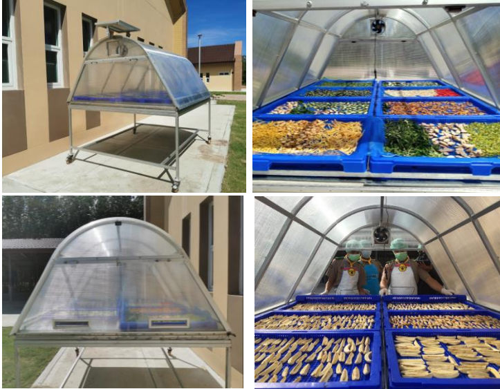
ภาพที่ 4 ระบบบอบแห้งพลังงานแสงอาทิตย์แบบครวีเรื่อน ขนาดกว้าง 1.8 เมตร x ยาว 2.1 เมตร
