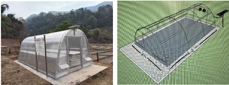
ภาพที่ 5 ระบบบอบแห้งพลังงานแสงอาทิตย์แบบพาราโบลาโดม ขนาดกว้าง 3 เมตร x ยาว 6.2 เมตร
