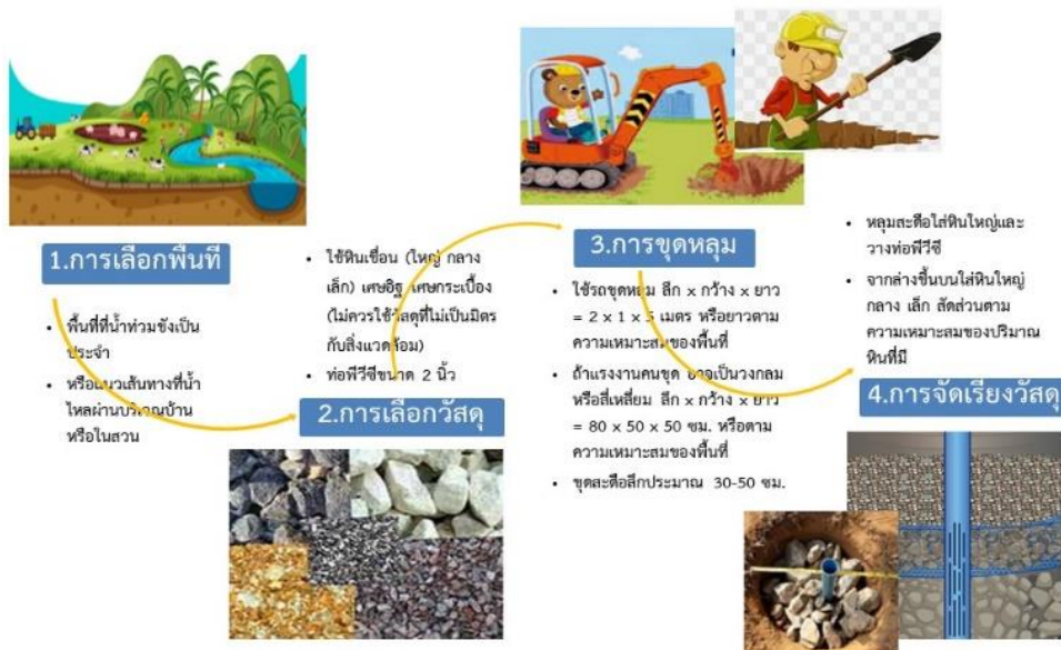
ภาพที่ 4.4 สี่ขั้นตอนของนวัตกรรมการทำธนาคารน้ำใต้ดินระบบปิดของ อบต.ถ้ำสิงห์ (ที่มา: ออกแบบโดยผู้วิจัย)
