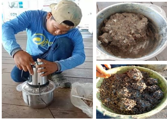
รูปที่ 14 การใช้เครื่องบดปลาแบบละเอียดเมื่อปั่นรวมกับอาหารเม็ดช่วยลดการสูญเสียอาหารเม็ดได้
