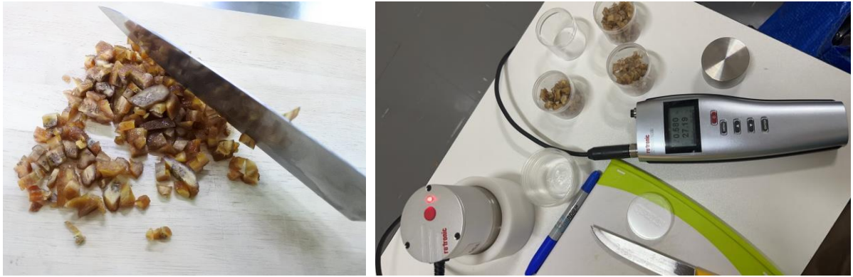
ภาพที่ 4.25 วิธีการเตรียมตัวอย่างและการวิเคราะห์ค่าวอเตอร์แอกติวิตี้
