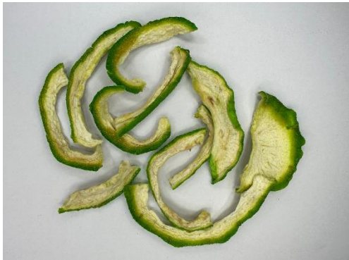
ค. ตัวอย่างที่ความหนา 8 มิลลิเมตรที่ผ่านการ อบแห้งด้วยตู้อบลมร้อนเป็นเวลา 8 ชั่วโมง
