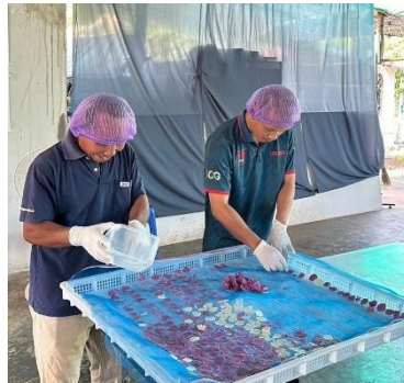
ขั้นตอนการหั่นแผ่นข้าวเกรียบ วางบนตะแกรงและนำเข้าตากในระบบอบแห้งๆ จนแห้งดี
