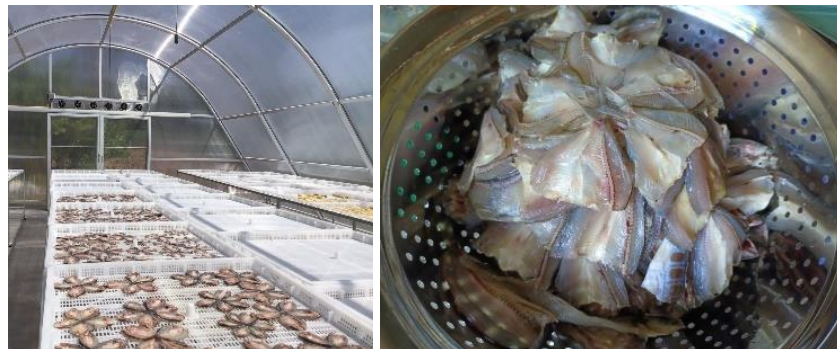
การตากปลาวางในระบบอบแห้งพลังงานแสงอาทิตย์แบบพาราโบลาโดม
