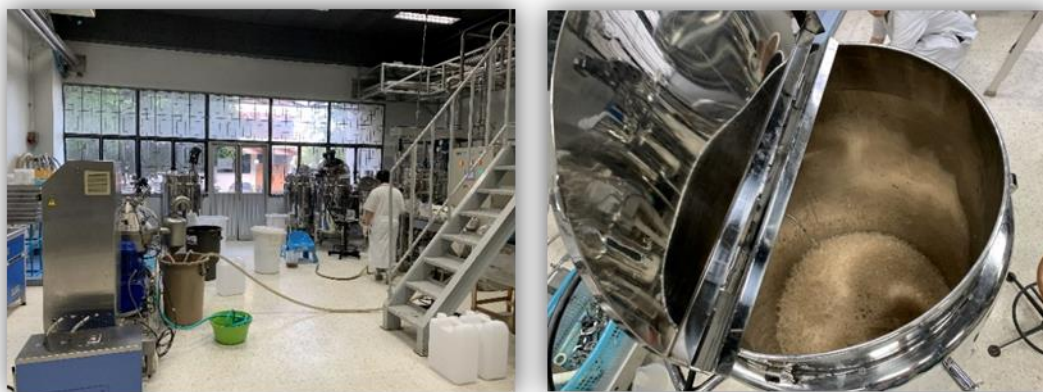
ภาพที่ 7 การแยกกากเซลล์ของ M. yunnanensis P2-23 ออกจากน้ำเลี้ยงเชื้อที่มีสารชีวภัณฑ์ IAA ด้วยเครื่องปั่นเหวี่ยงตะกอนเซลล์แบบต่อเนื่อง (continuous centrifuge)
