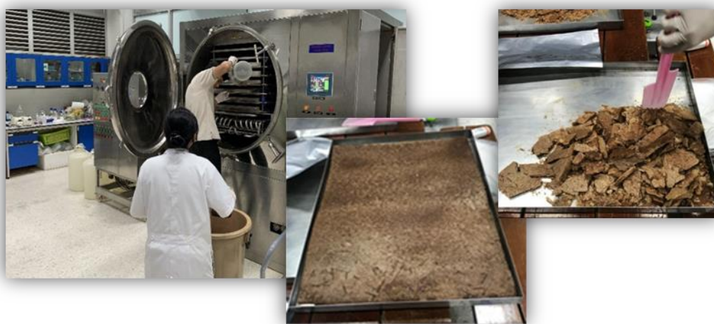
ภาพที่ 22 การทำผลิตภัณฑ์สารชีวภัณฑ์ IAA แบบแห้งด้วยเครื่องระเหิดเย็น
