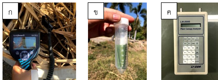
รูปที่ 13 อุปกรณ์ในการตรวจติดตามการฟื้นตัวของอ้อย ก) การวัดความชื้นในดิน ด้วยเครื่อง Hydro Sense II ข) การเก็บใบอ้อยขนาด 5 เซนติเมตร เพื่อวัดค่าปริมาณน้ำสัมพัทธ์ในใบ และ ค) เครื่อง Plant Canopy Analyzer LAI-2000 สำหรับการวัดดัชนีพื้นที่ใบ
