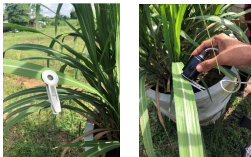
รูปที่ 14 ลักษณะการวัดการตอบสนองของใบต่อฟลูออเรสเซนซ์ ด้วยเครื่อง Handy PEA
