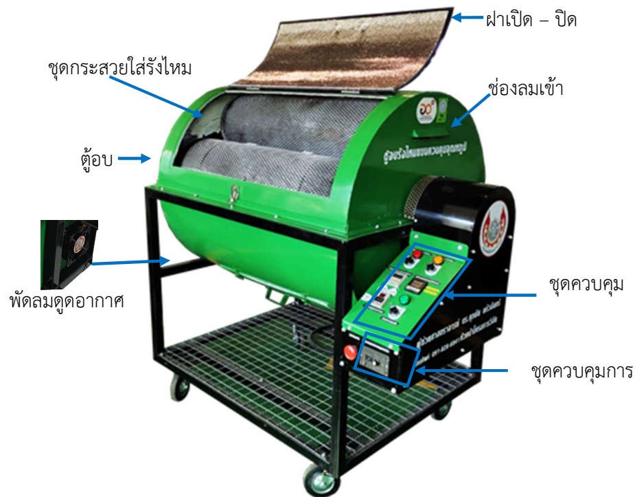
ภาพที่ 2 ส่วนประกอบตู้อบรังไหมแบบควบคุมอุณหภูมิ เพื่อการเก็บรักษารังไหม
