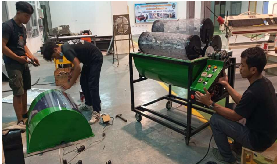
ภาพที่ 70 การประกอบชุดกระสวยใส่รังไหมสำหรับการอบรังไหมแบบควบคุมอุณหภูมิ ใช้เหล็กแผ่นตะแกรงมี รูขนาด 4 มิลลิเมตรนำมาหมุนขึ้นรูปให้ได้ขนาด 200 มิลลิเมตร ยาว 600 มิลลิเมตร จำนวน 5 ลูก สามารถใส่ รังไหมได้ครั้งละ 10 กิโลกรัม
