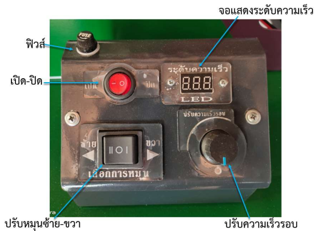
ภาพที่ 23 ชุดแผงควบคุมระบบการทำงานชุดตีเกลียวเส้นไหม
