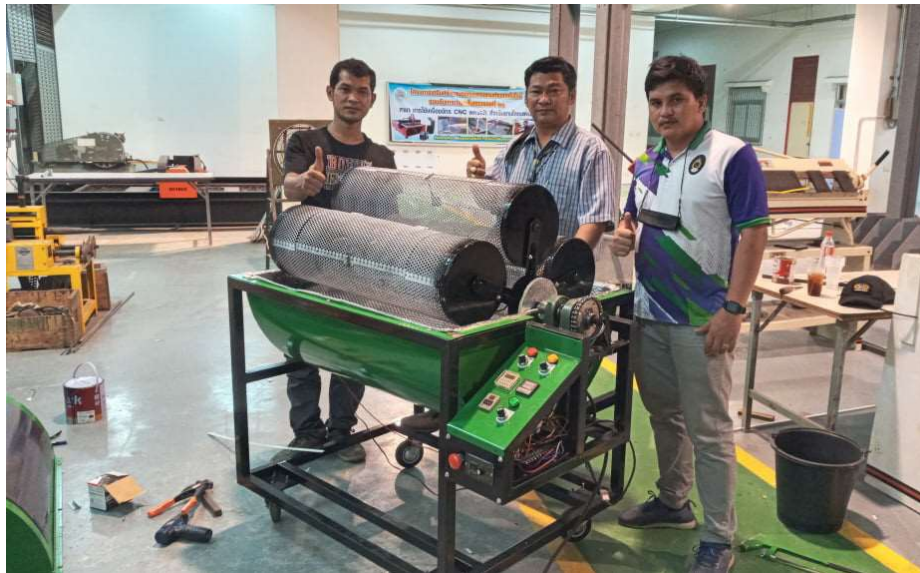
ภาพที่ 71 ประกอบชุดควบคุมการทำงานของตู้บรีงใหม่แบบควบคุมอุณหภูมิ ใช้สำหรับตั้งระบบการทำงาน สามารถตั้งอุณหภูมิความร้อนภายในตู้บรีงขณะอบ และควบคุมความร้อนภายในตู้บตามที่ตั้งไว้ ควบคุมพัดลมระบายความชื้นภายในตู้บออกจากตู้ ควบคุมการหมุนของกระสวยใส่รังไหมให้หมุนพลิกรังไหมขณะอบได้
