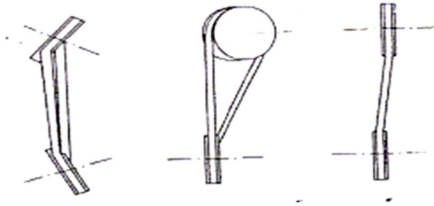
ภาพที่ 62 การตรวจสอบแนวศูนย์พูลเลย์ ที่มา : (บุญธรรม นิธิอุทัย และชลดา เลวิส. 2560)
