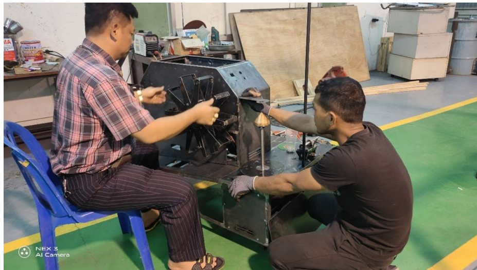
ภาพที่ 66 ประกอบชุดสว่านไหมและตีเกลียวเส้นไหมของเครื่องผลิตเส้นไหมทอมือพลังงานแสงอาทิตย์ แบบครบวงจร ใช้มอเตอร์ DC มอเตอร์ 12 โวลต์ เป็นต้นกำลังในการขับเคลื่อนการขับเคลื่อนเส้นไหม โดยใช้สายพาน เป็นตัวส่งกำลังผ่านมู่เลย์ไปยังเพลาขับเคลื่อนเส้นไหม
