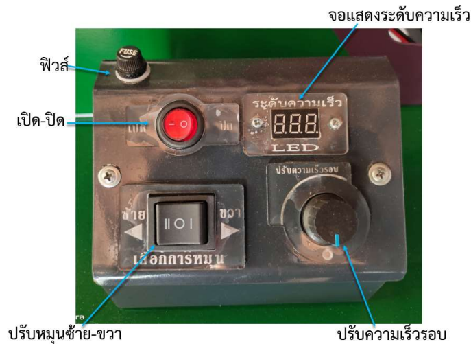
ภาพที่ 21 ชุดแผงควบคุมระบบการทำงานชุดสาวไหม
