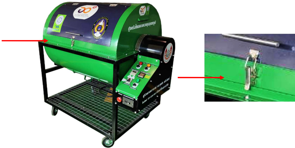
ภาพที่ 9 การปิดตู้อบและชุดล็อคฝาปิดตู้อบ
