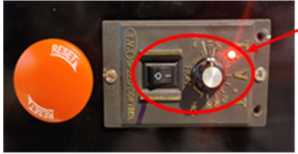
ภาพที่ 11 ชุดสวิตซ์ควบคุมความเร็วในการหมุนกระสวย
