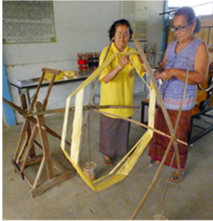
ภาพที่ 43 การเตรียมเส้นไหมที่ต้องการกัก เข้าสวมกง
